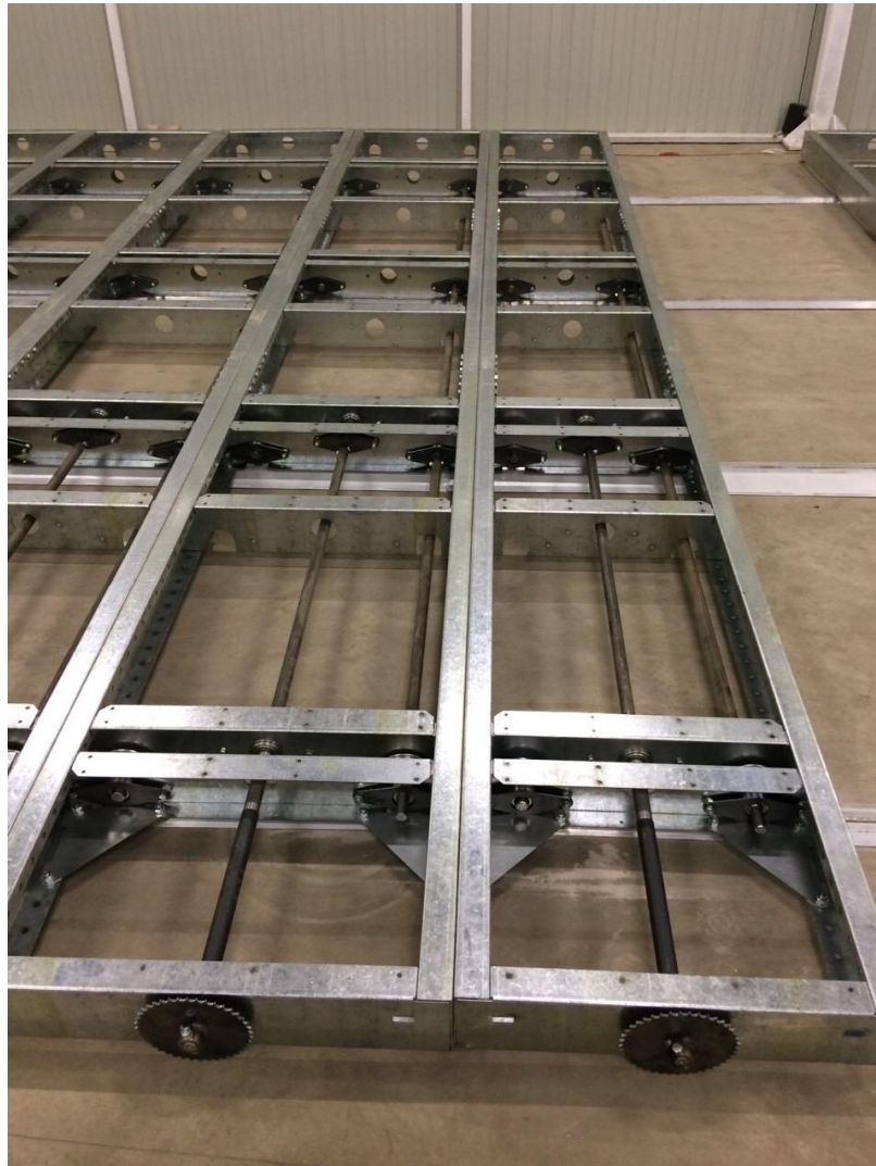
Рис. 5 Усиленные сборные мобильные рамы, установленные на рельсы, подготовлены к установке каркасной части стеллажей.
