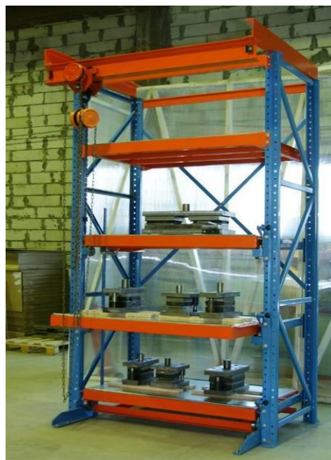
Рис 2 Стеллаж Slide со встроенной механической талью. Не полное выдвижение полки
